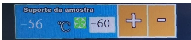
O suporte de amostra possui controle de temperatura independente, sendo que essa temperatura é de extrema importância para conservar a amostra em temperaturas baixas para se obter cortes regulares e finos.
