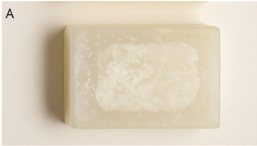
Figura A: La temperatura hasta 65°C, no altera la coloración de la parafina, garantizando la preservación de la muestra
