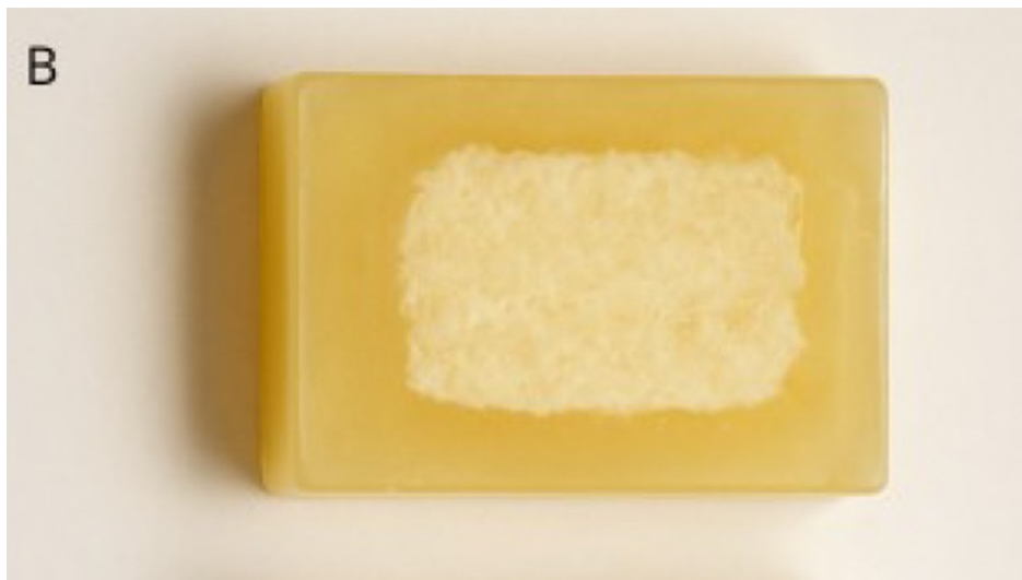
Figura B: : Amarelada devido à temperatura acima de 65°C.
