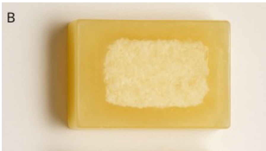
Figura B: : Amarillenta debido a la temperatura por encima de 65°C.
