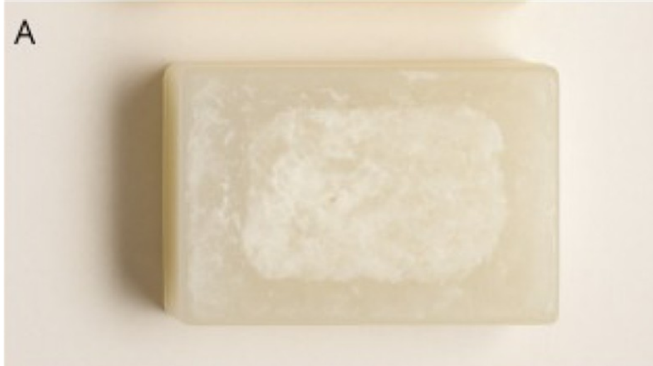
Figura A: A temperatura até 65°C, não altera a coloração da parafina, garantindo a preservação da amostra
