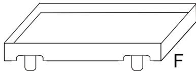
Base de aço reforçada, carrinho (F), possui duas rodas fixas com trava na parte dianteira e duas rodas móveis na parte traseira.
